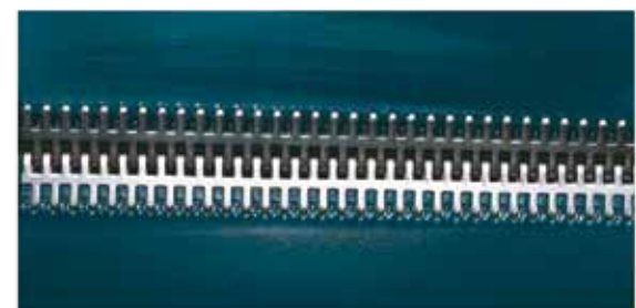
Esempio di Giunzione MG
